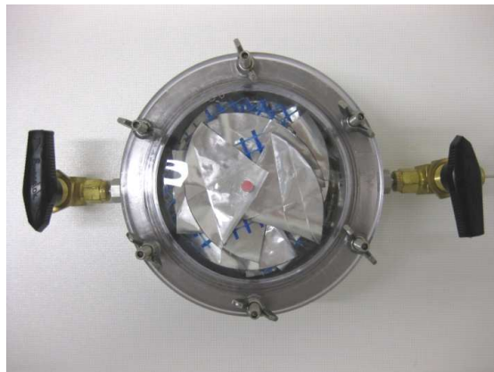
Zelle mit Sauerstoff-Absorber und eingestellter Durchlässigkeit
